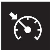
2. Utilice el pedal del acelerador para ajustarse a la velocidad deseada del vehículo. Más de 40 km/h. Una vez alcanzada la velocidad deseada, opere "SET" y el vehículo alcanzará la velocidad configurada por el interruptor en el momento en que opere. La luz indicadora del control de crucero se enciende (verde).
