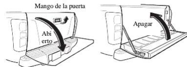
Abra la manija de la puerta trasera, desbloquee la cerradura y abra lentamente la puerta trasera. Cierre lentamente la puerta trasera de la caja de carga, cierre la puerta trasera y asegúrese de que esté bloqueada en su lugar.
